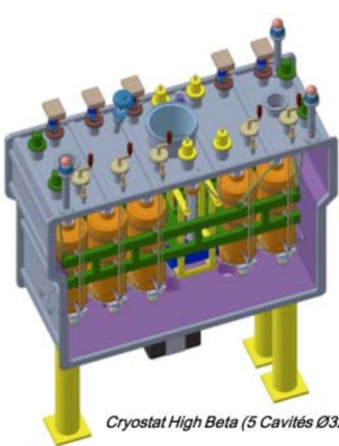
*Cryostat High Beta (5 Cavités Ø320)*
