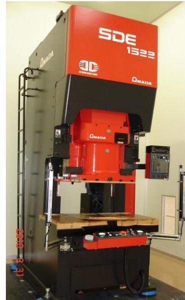
Press machine (servo control)
