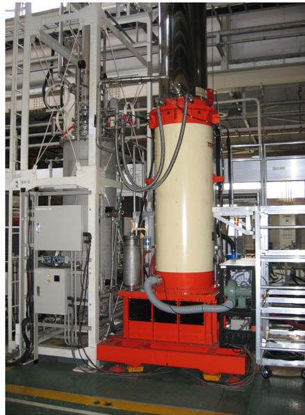
1.2MW CW klystron
