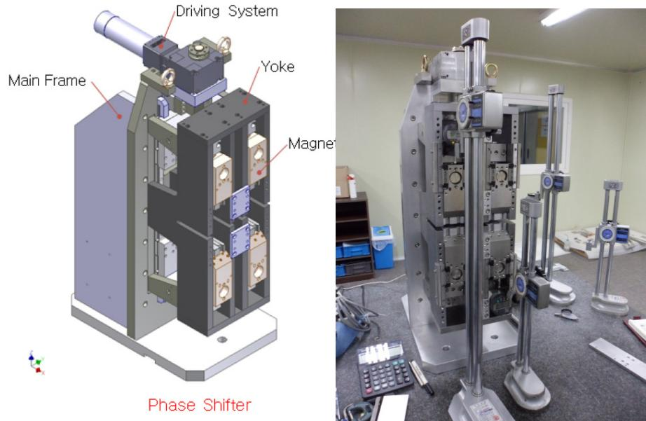
그림 1 Phase Shifter 3D 모델링(전면부)
