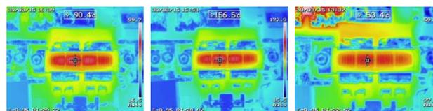
50 ohm load Die temp 90C. 3:1 low Z load. Die temp 156C. 3:1 high Z load. Die temp 53C.
