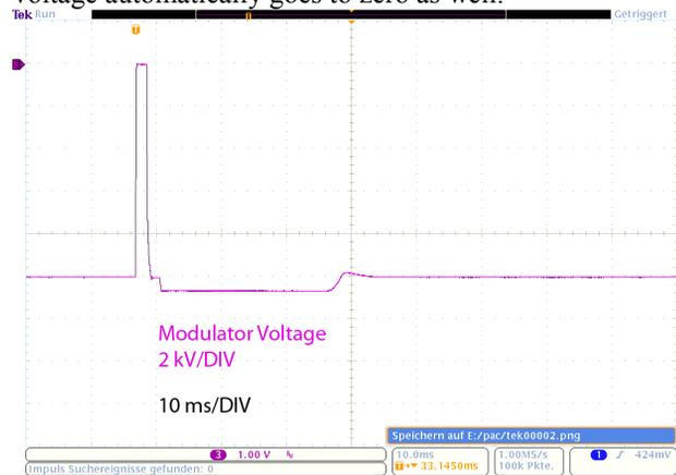
Figure 8: Transformer demagnetisation.
