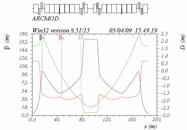
Figure 4: Arc module, 2TeV  $\mu^+\mu^-$  collider
