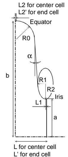
Fig. 9 Cavity shape parameters
