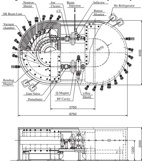
Fig. 2-a) Schematic of A2S.
