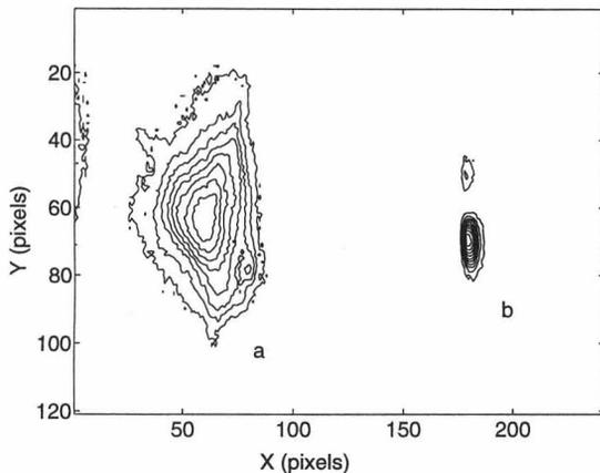
Fig. 3. a) 280 nA N<sup>+</sup> on 996 Alumina, b) 100 nA on Chromox-6.
