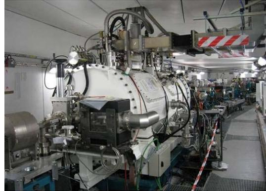
Figure 5 : Cryomodule n°1 (CM1) in the SOLEIL SR.
