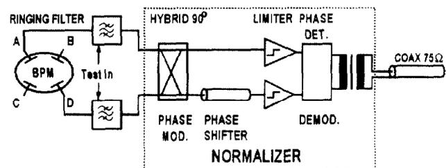
Fig. 1 : Narrow Band Processing Scheme.
