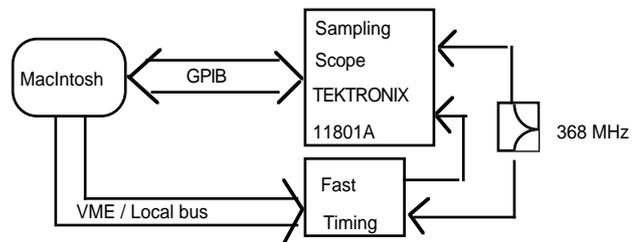
Figure 2 : Bucket phase shift test set.
