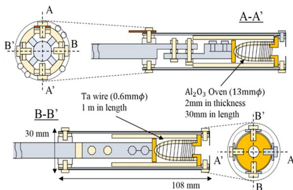
Figure 3:  $C_{60}^+$  crucible.
