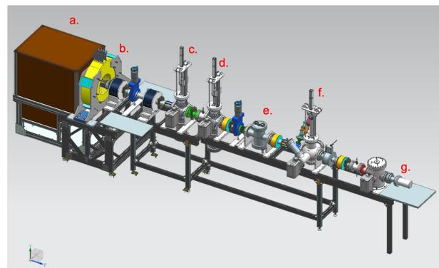
Figure 4: Diagnostic beamline: (a) Gun in faraday cage, (b) Magnetizing solenoid, (c) Viewer 1, (d) Viewer 2/1DPP, (e) DQW Cavity, (f) Viewer 3, (g) Beam dump.
