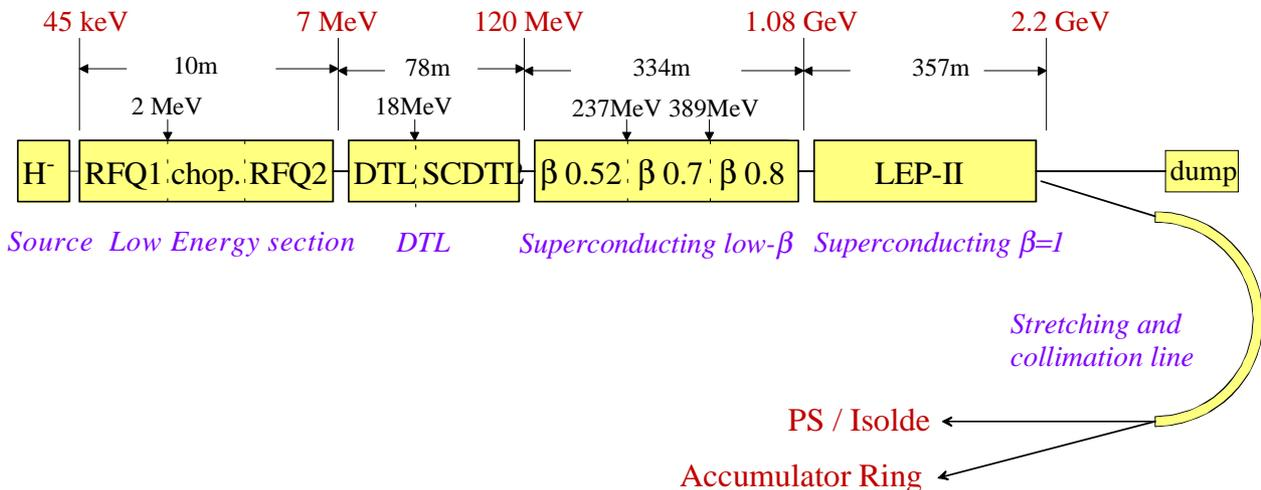
Figure 4 : Layout of the SPL H<sup>-</sup> linac
