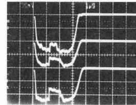
(d) electron beam loading of rf power
