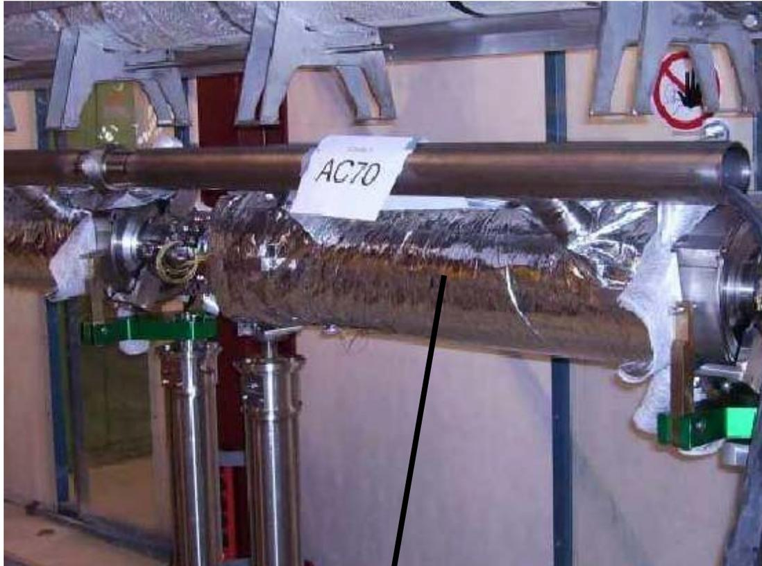
**2 K Helium Vessel of TESLA Cavity**
